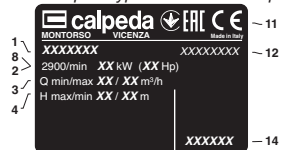
Beispiel Typenschild des Motors
