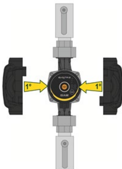
Rysunek 7: Izolacja korpusu pompy
