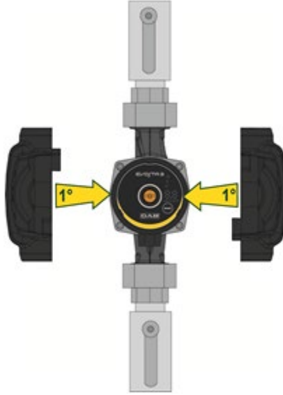
Resim 7: Pompa gövdesinin yalıtımı
