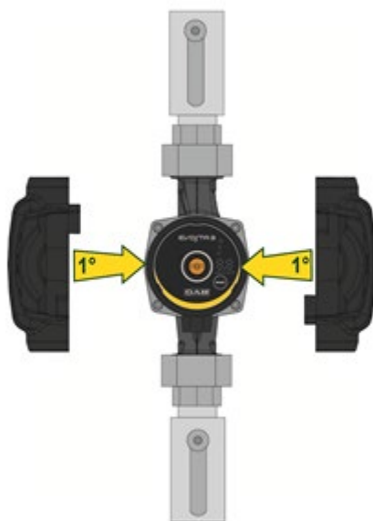
Εικόνα 7: Μόνωση του σώματος της αντλίας
