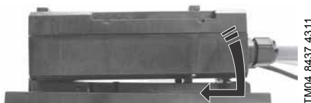
Рис. 7 Установка модуля E-Box на монтажной плите
