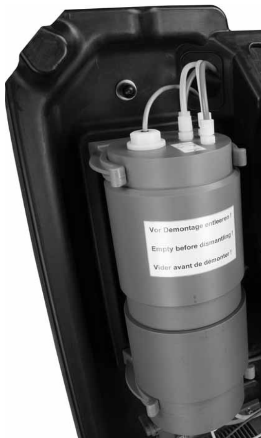
Рис. 43 Реактор и резервуар-накопитель на опоре (OCD-162-5, -10)
