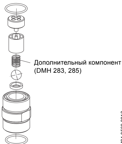
Рис. 38 Клапан исполнения DN 20 из нержавеющей стали
