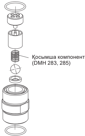
38-сур. Тот баспайтын болаттан жасалған DN 20 орындалуындағы клапан
