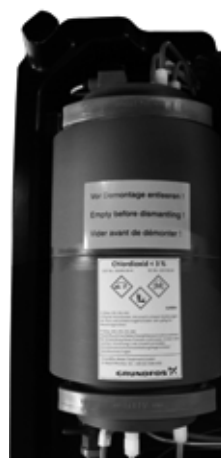
Рис. 40 Реактор с внутренним дозирующим резервуаром OCD-162-10
