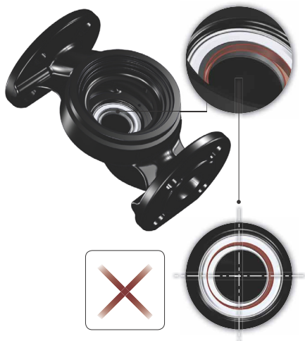
Рис. 12 Неправильно выровненная система уплотнений
