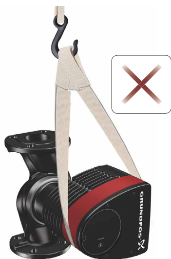
Рис. 6 Неправильный способ подъёма насоса
