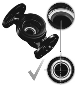
15-сур. Тығыздағыштың дұрыс теңестірілген жүйесі
