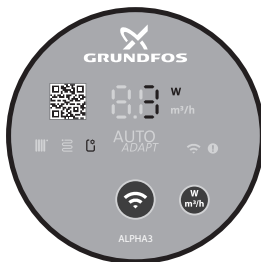
23-сүр. Туруктуу басым шарттамында башкаруу панели
