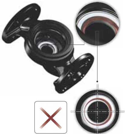
Рис. 8 Неправильно выровненная система уплотнений
