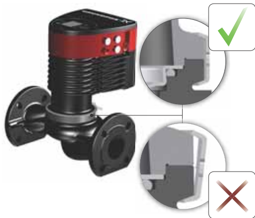
Рис. 13 Закрепление головной части насоса на корпусе насоса
