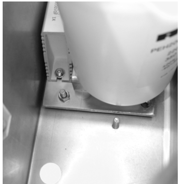
Рис. 38 Резистор R1 (ограничения пускового броска тока)
