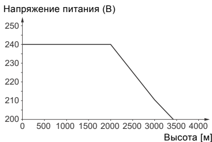
Рис. 16 Напряжение питания для однофазного электродвигателя в зависимости от высоты над уровнем моря
