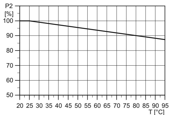
Рис. 20 Соотношение мощности двигателя (P2) и температуры окружающего воздуха
