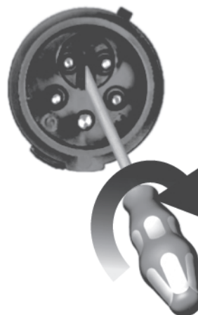
Рис. 3 Смена фаз трёхфазного шкафа управления с фазовым инвертером
