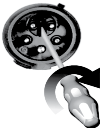
Рис. 28 Смена фаз трёхфазного шкафа управления с фазовым инвертером
