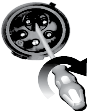
Сүр. 28 Фазалык инвертер менен үч фазалык башкаруу шкафын фазаларын алмаштыруу
