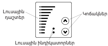
Նկար 17 Միաֆազ Էլեկտրական շարժիչով պոմպի կառավարման վահանակ
