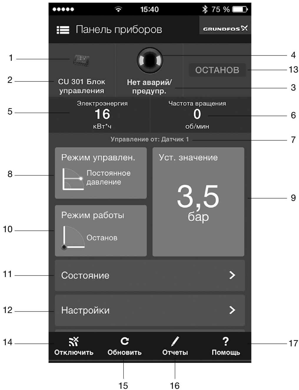
Рис. 25 Устройство беспроводного управления Grundfos Go
