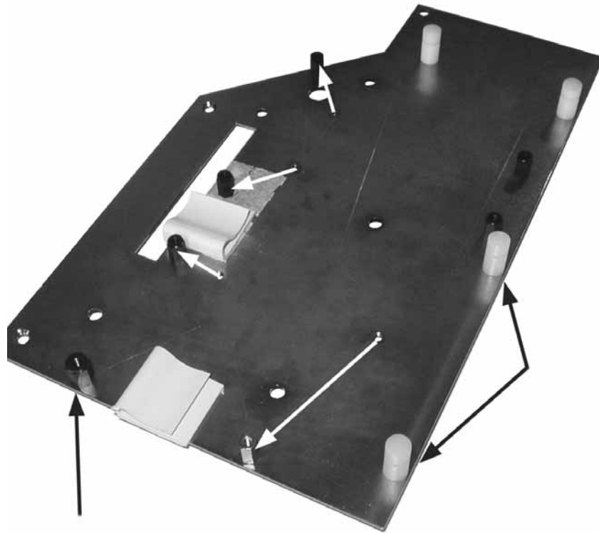
Рис. 28 Разделители, извлекаемые для демонтажа платы
