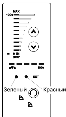
Рис. 42 Световые индикаторы на насосах с трёхфазными электродвигателями
