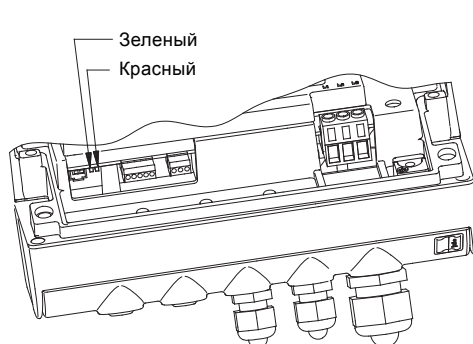
Рис. 37 Световые индикаторы на насосах с однофазными электродвигателями
