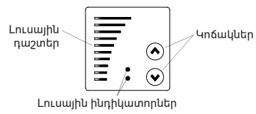
Նկար 17 Միաֆազ Էլեկտրական շարժիչով պոմպի կառավարման վահանակ
