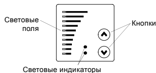
Рис. 17 Панель управления насосом с однофазным электродвигателем
