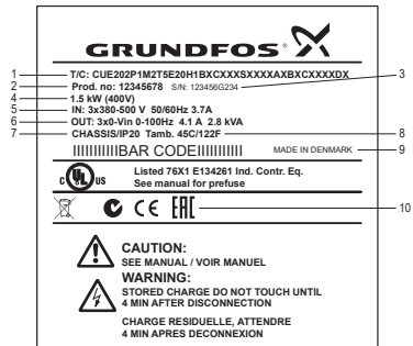
3-сүр. Жыштык өзгөрткүчтүн фирмалык көрнөкчөсү
