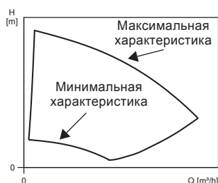
Рис. 42 Максимальная и минимальная характеристики производительности
