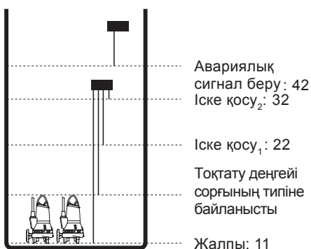
24-сур. Екі сорғымен жабдықталған кәріздік сұйыққоймадағы электродтар
