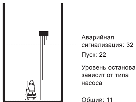
Рис. 23 Электроды в канализационном резервуаре, оборудованном одним насосом
