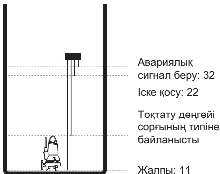
18-сур. Бір сорғымен жабдықталған кәріздік құдықтағы электродтар
