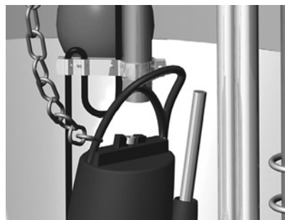
Рис. 15. Подъемная цепь, прикрепленная к насосу
