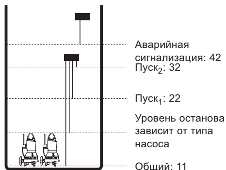
Рис. 19. Электроды в канализационном колодце, оборудованном двумя насосами
