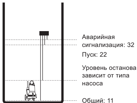
Рис. 18. Электроды в канализационном колодце, оборудованном одним насосом
