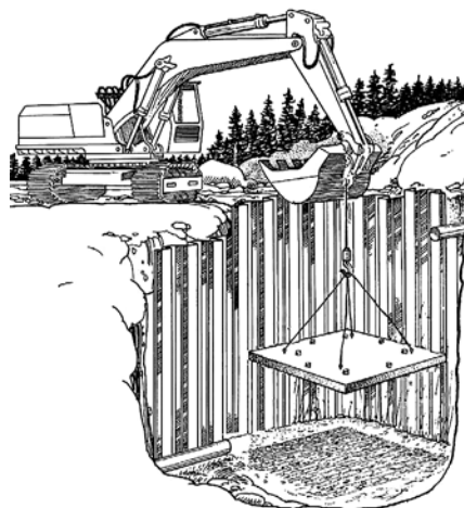
8-сүр. Фундаменттик плитаны түшүрүү
