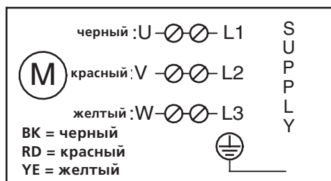
Рис.13 Пуск по схеме прямого включения
