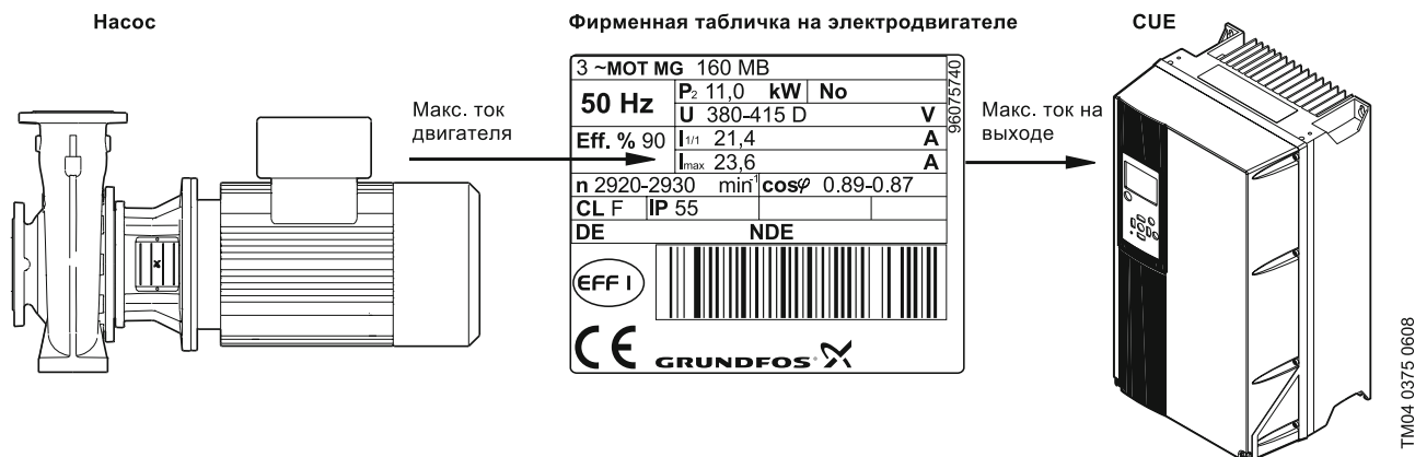
Рис. 95 Подбор CUE на основании максимального тока двигателя
