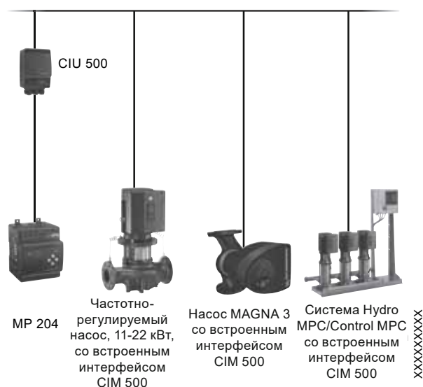
Рис. 138 CIM/CIU 500 в сети PROFINET IO
