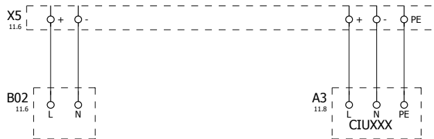
ПИТАНИЕ ЭЛЕКТРОДНОГО РЕЛЕ 24VDC
