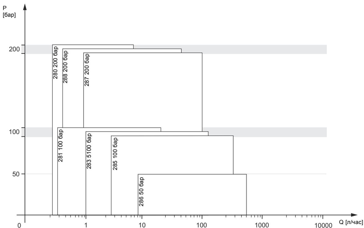
Рис. 2 Диапазон производительности DMH 28x
