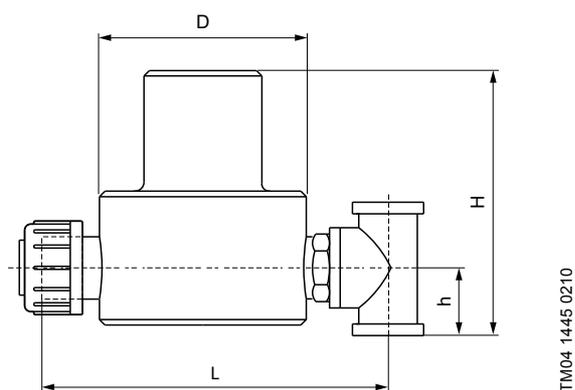
Рис. 57 Клапан сброса давления, G 5/4, G 2
