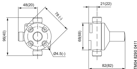
Рис. 42 Предохранительный клапан. Размеры, указанные в скобках, относятся к исполнению из нержавеющей стали.
