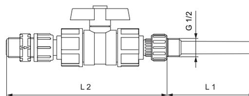
Рис. 37 Блок впрыска с шаровым клапаном
