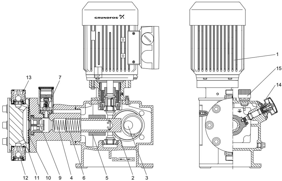
Рис. 19 Чертеж в разрезе, модель DMH 254
