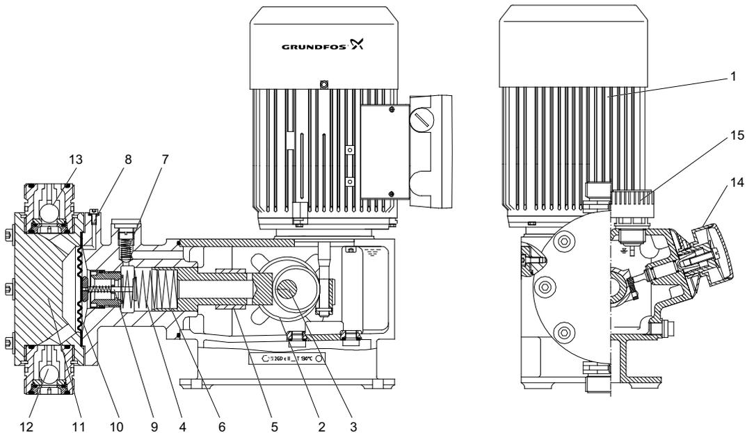
Рис. 18 Чертеж в разрезе, модель DMH 253
