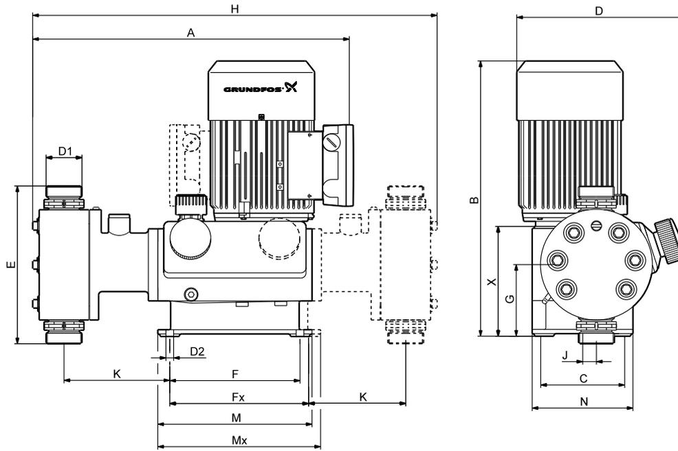
Рис. 26 Размеры, модели DMH с 280 по 288
