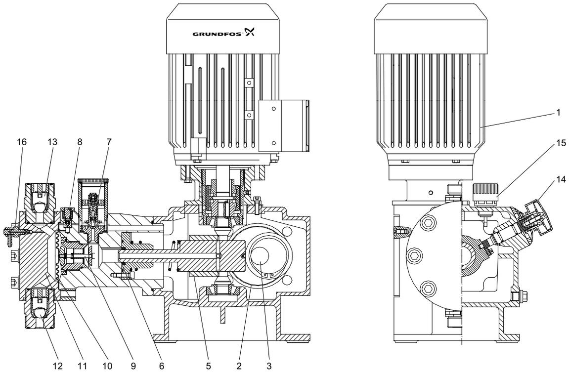
Рис. 23 Чертеж в разрезе, модели DMH 283, 288
