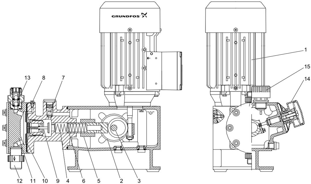
Рис. 17 Чертежи в разрезе, модели DMH 251, 252
