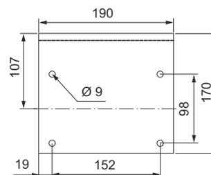
Рис. 81 Настенный кронштейн для моделей DMX 226 и DMH 251/251
