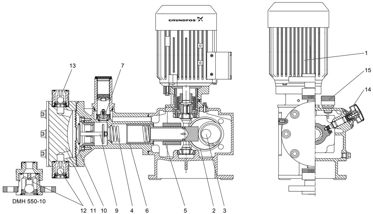
Рис. 20 Чертеж в разрезе, модель DMH 255
