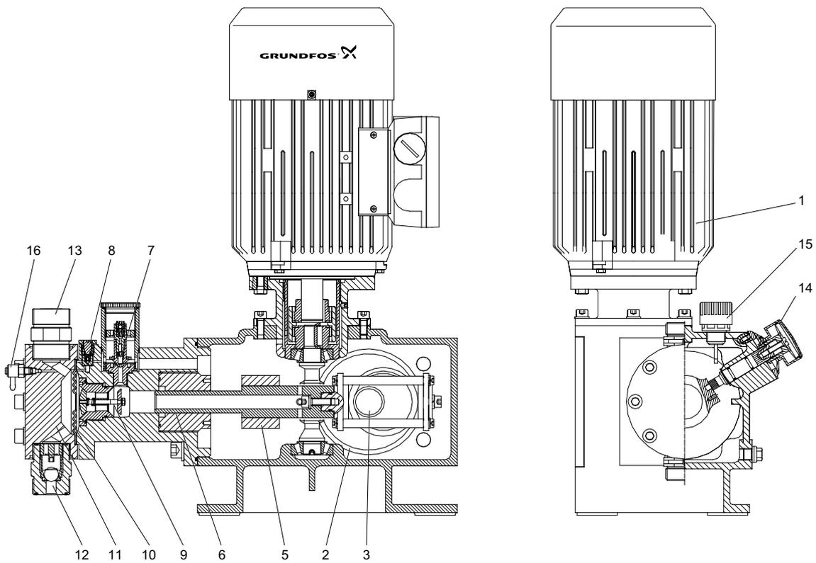
Рис. 24 Чертеж в разрезе, модели DMH 285, 286, 287
