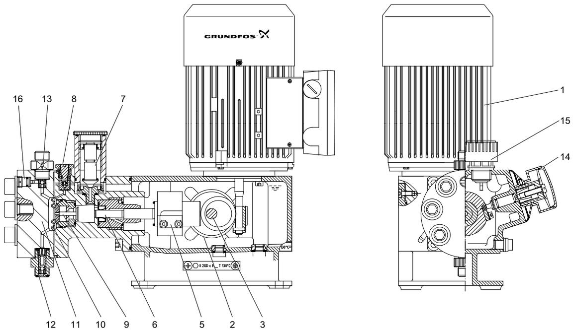
Рис. 22 Чертеж в разрезе, модель DMH 280
