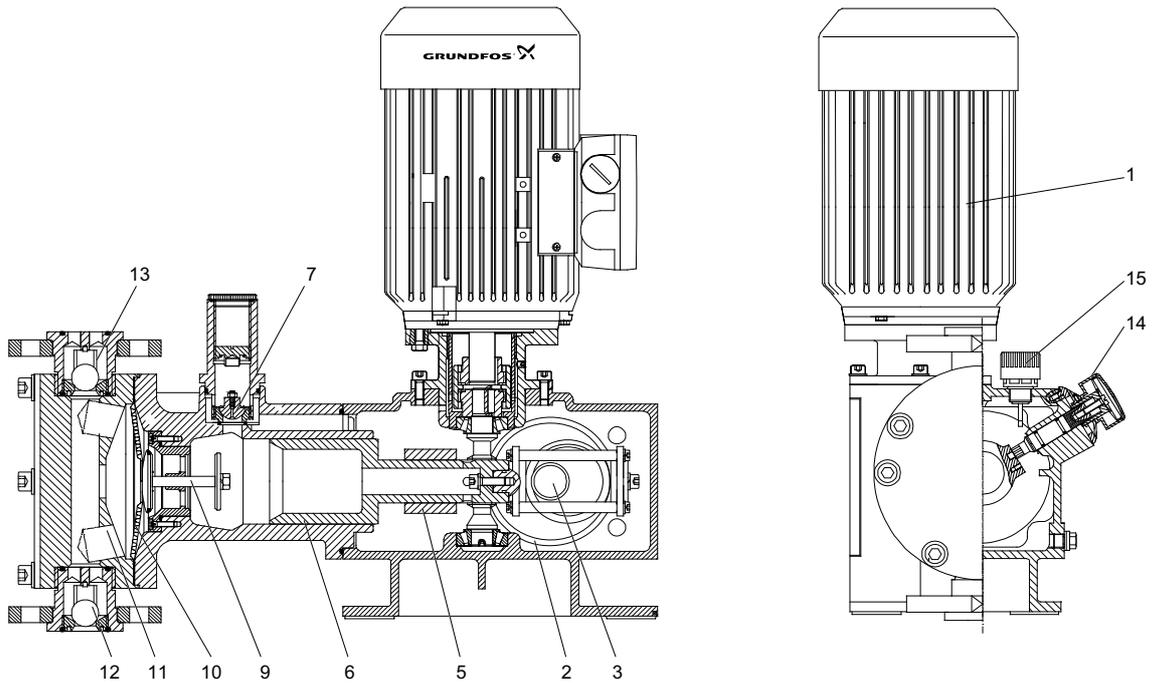
Рис. 21 Чертеж в разрезе, модель DMH 257
