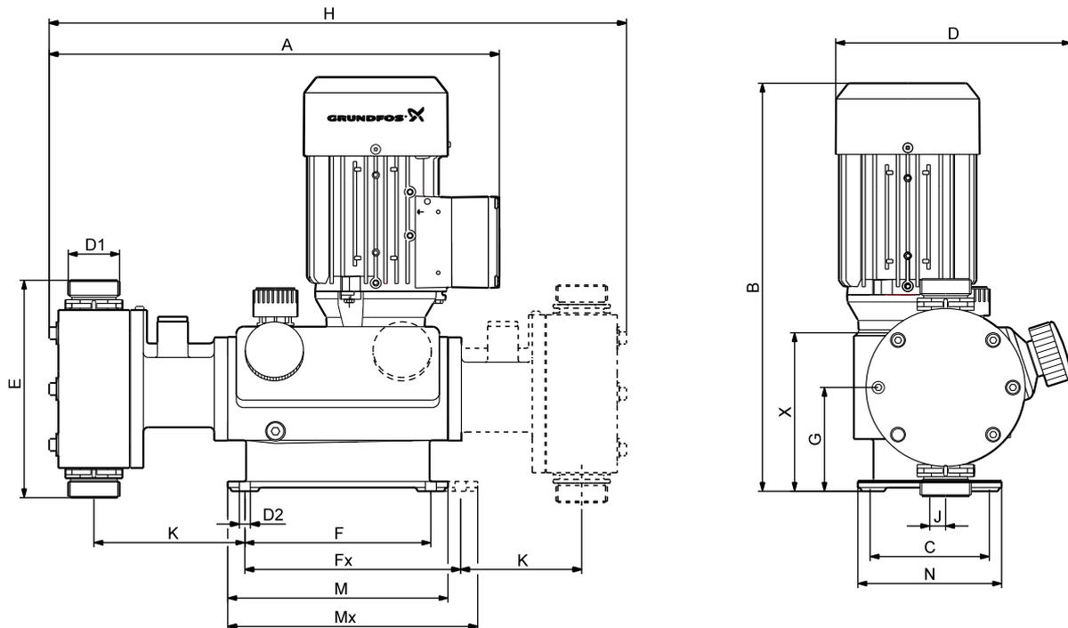
Рис. 25 Размеры, модели DMH с 251 по 257
