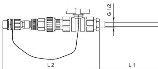
Рис. 38 Блок впрыска, который можно снимать для очистки
