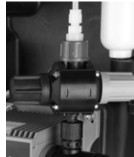
Рис. 42 Многофункциональный клапан на дозировочном насосе
