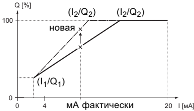
Рис. 20 Настройка масштабирования (меню «Работа»)
