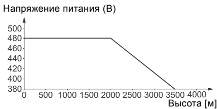
Рис. 15 Напряжение питания для трёхфазного электродвигателя в зависимости от высоты над уровнем моря
