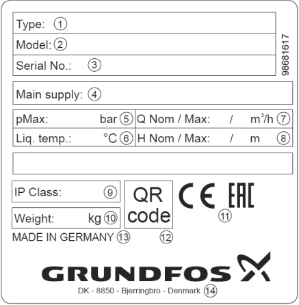
Նկար 3 CMBE TWIN ֆիրմային վահանակի արտաքին տեսքը
