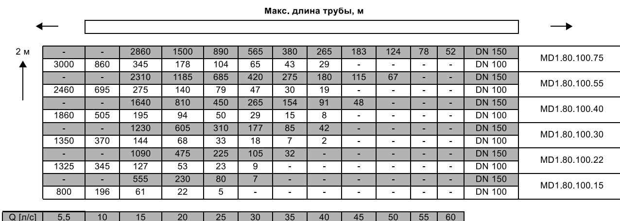
Рис. 111. Максимальная длина вертикальных или горизонтальных напорных трубопроводов
