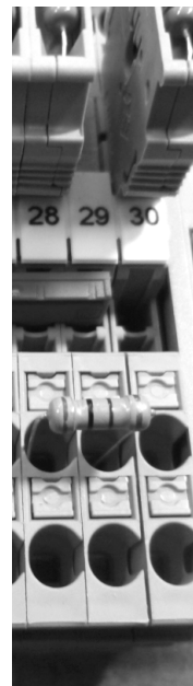
4-сур. PTC датчигін қосу клеммаларында кедергі (резистор) орнату мысалы
