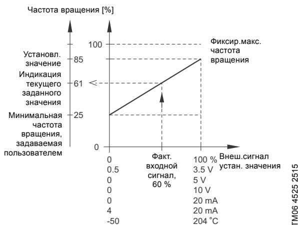
Рис. 73 Пример влияния установленного значения с постоянной характеристикой
