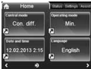
Рис. 1 Пример главного дисплея на насосе TPE серии 2000
