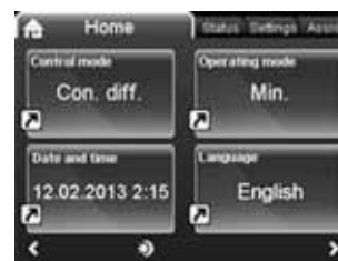
Рис. 16 Пример главного дисплея на насосе TPE серии 2000
