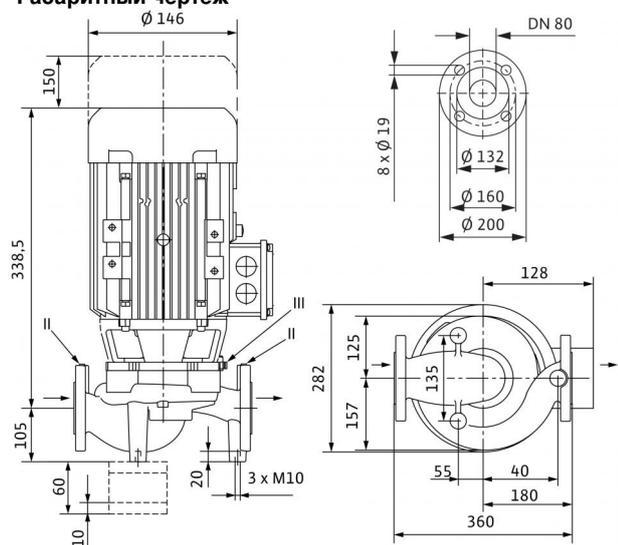
Указание: Корпус с опорными ножками для монтажа на фундаменте, консоли по запросу; II отверстие для измерения давления R1/8; III удаление воздуха R1/8
