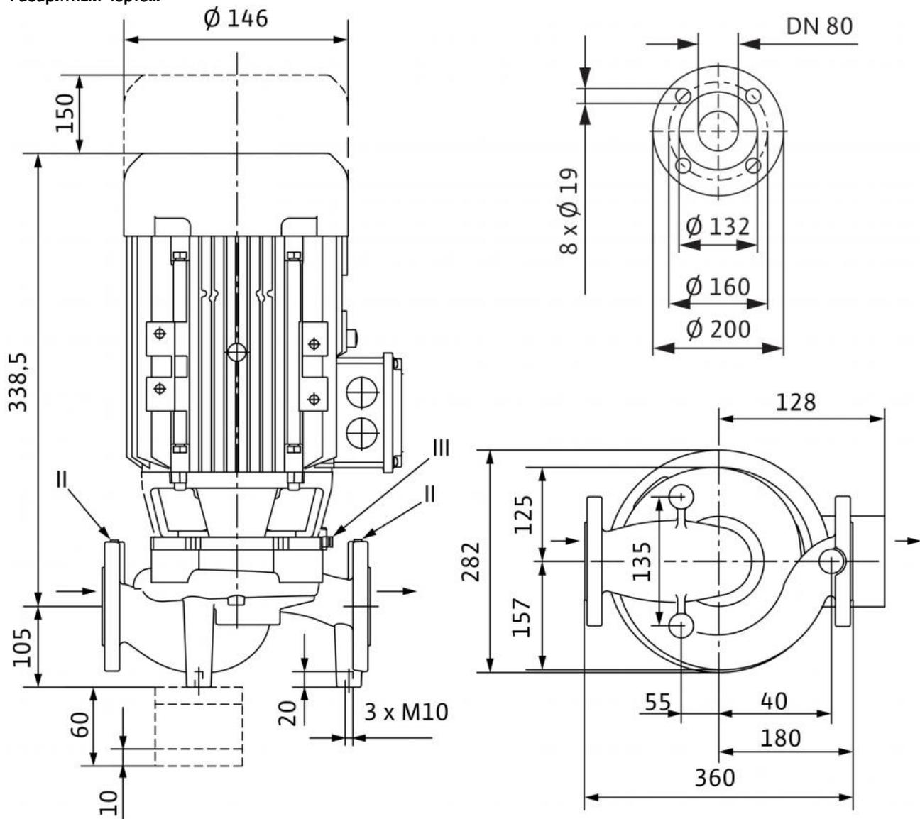
Указание: Корпус с опорными ножками для монтажа на фундаменте, консоли по запросу; II отверстие для измерения давления R1/8; III удаление воздуха R1/8
