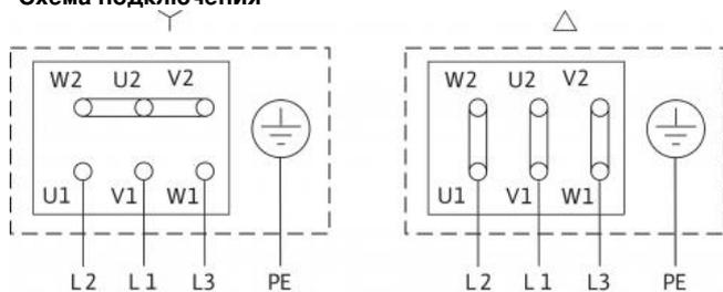
Δ: Схема соединения – треугольник
