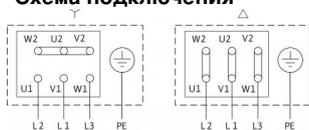
Δ: Схема соединения – треугольник
